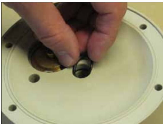
Bild 9. Setzen Sie O-Ring Mittelblockdichtung (47) in die Nut.
