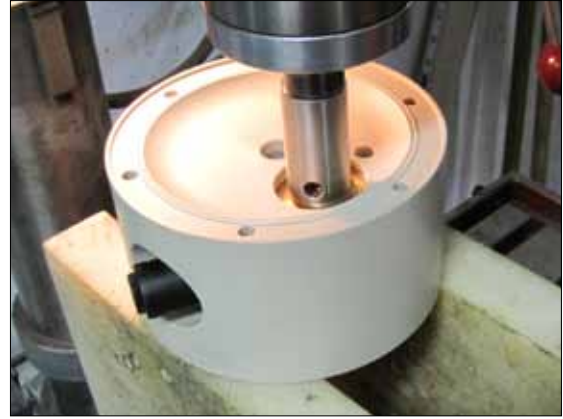
Bild 12. Drücken Sie das Steuerventil (61) vorsichtig mit einem Dorn aus dem Gehäuse. Achten Sie darauf, die Messingkanten nicht zu beschädigen.
