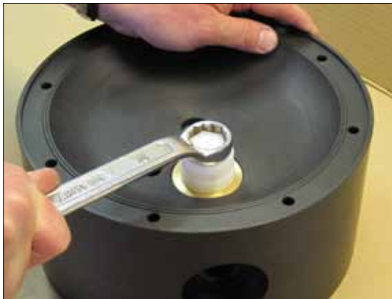
Bild 13. Schrauben Sie die Endkappen des Steuerventils mit einem Montagewerkzeug (282) vorsichtig auf beiden Seiten aus.
