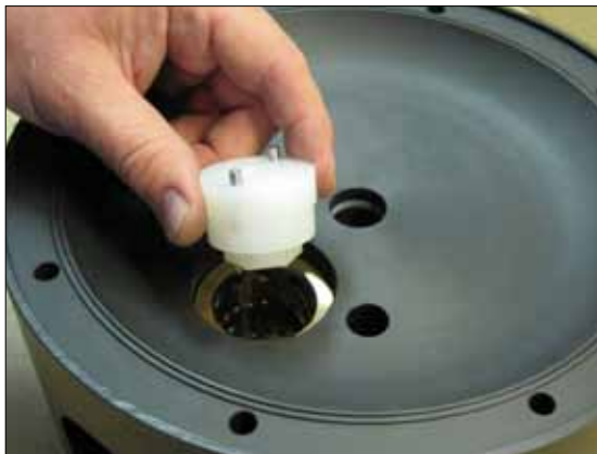
Bild 15. Um die Ventilhülse aus dem Mittelblock zu drücken, nehmen Sie die andere Seite des Montagewerkzeuges.
